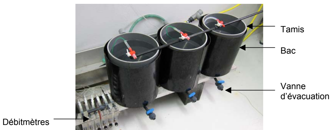
Fig. 34 : photo du système utilisé au COP pour l'élevage larvaire expérimental en circuit ouvert.
