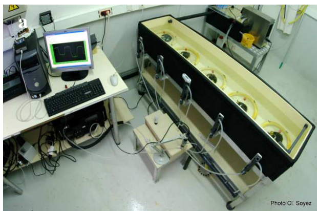
Figure 6 : (a) système de mesures automatisées de la fluorescence et de l'oxygène, (b) bilan énergétique des huîtres perlières en fonction du pH après 3 mois d'exposition.
